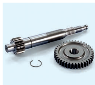
202.1429 Piaggio ZIP 50 4T Euro 4/5 Z=14-39 Primary ratio-Primario
