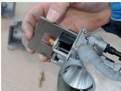
FLOAT LEVEL CHECK CONTROLLO LIVELLO GALLEGGIANTE
