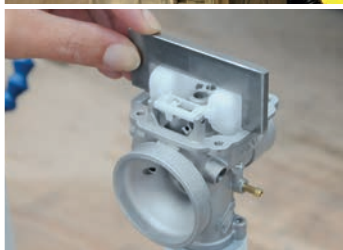
FLOAT LEVEL CHECK CONTROLLO LIVELLO GALLEGGIANTE
