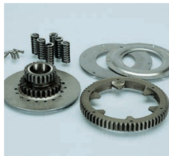
202.0001 Vespa P200E,T5 Z=23/64 Primary ratio-Primario
