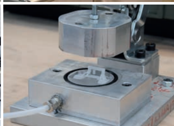
FLOAT SEAL CHECK CONTROLLO TENUTA GALLEGGIANTE
