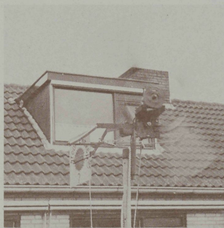
• Windmolen in proefopstelling, op een buis die aan de schuur is bevestigd.
