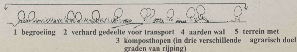
■ Figuur 2: Doorsnede door het kompostbedrijf
