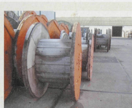
DE VURENHOUTEN PLANKJES VAN DEZE KABELHASPELS WORDEN HERGEBRUIKT ALS GEVELBEKLEDING
