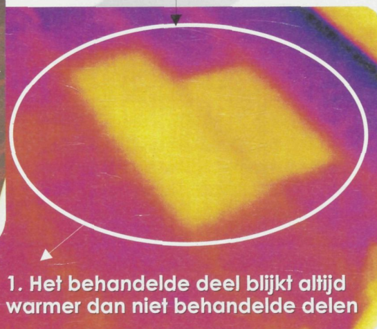
Infraroodfoto: Hot-spots op een begane grondvloer
